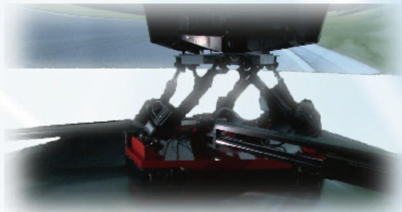
低周波領域での滑らかな動きと高周波領域での車両極限走行状態を表す圧倒的な性能により、車両モデルの挙動をリアルに再現
