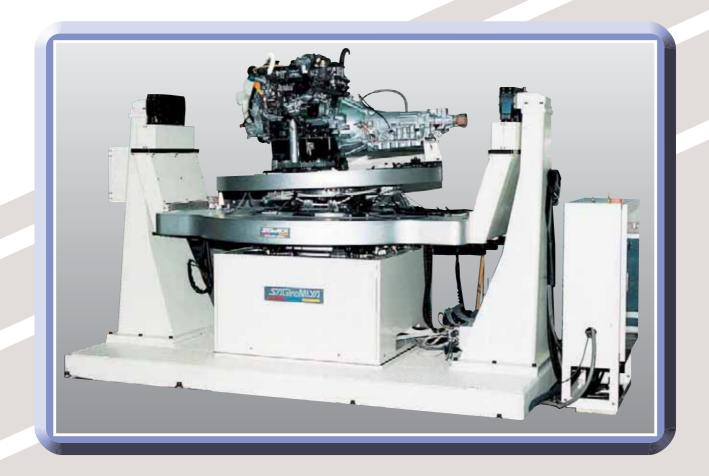
エンジン主慣性モーメント測定装置は、エンジン(ミッション付き)の主慣性モーメント値、慣性主軸の方向、質量や重心位置などの剛体特性を短時間に精度良く測定することが出来ます。エンジン振動の解析にこれらの確度の高い実測値を使用することで理想的なエンジンマウントの配置や特性を決めることが出来ます。エンジンの防振設計には不可欠な装置です。
