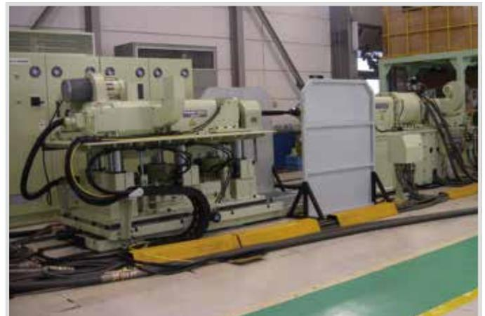
■ 駆動吸収型回転ねじり試験機
