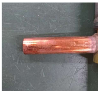
継手変色の実例
