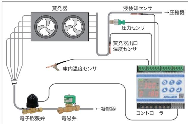
※温度-圧力制御、液検知センサ、庫内温度センサ使用
