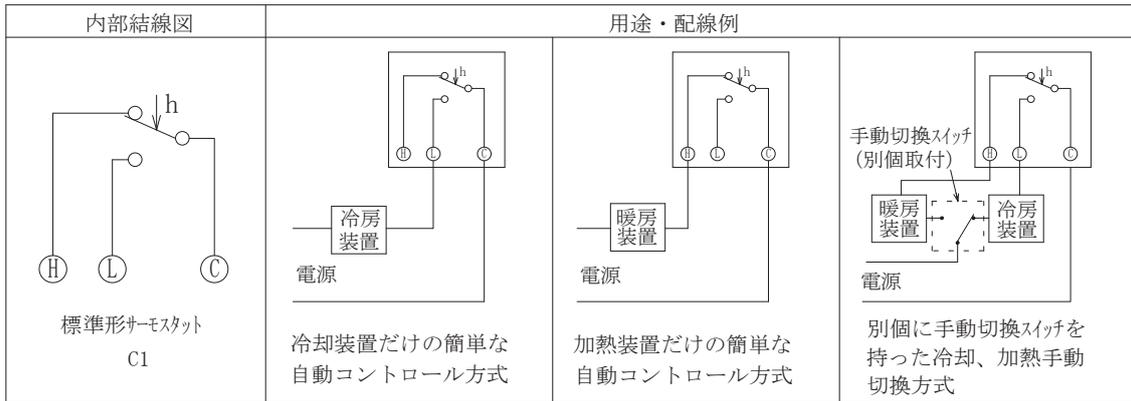
矢印→は温度上昇時の作動方向を示します。
