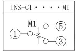
矢印↑は温度上昇時作動方向を示します。矢印↓M1は手動復帰方向を示します。
