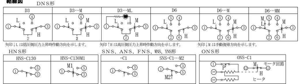
矢印↓Lは低圧側圧力上昇時作動方向を示します。矢印↑Hは高圧側圧力上昇時作動方向を示します。矢印↓Mは手動復帰方向を示します。
